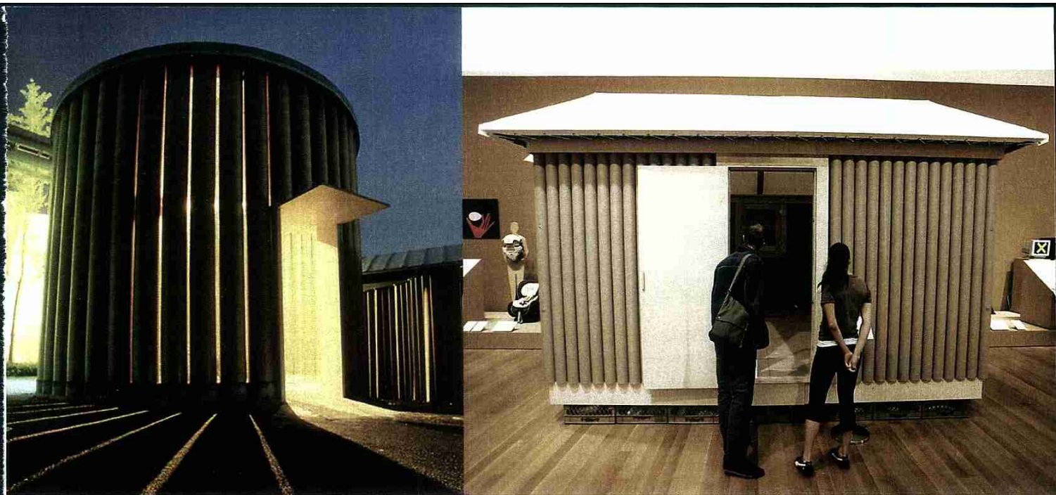
DE USO REAL. De izquierda a derecha, edificio Paper Arbor, construido en Nagoya (Japón), y una de las casas realizadas para servir de refugio a las víctimas del terremoto de Turquía de 1999. En este proyecto, los tubos de cartón sirvieron para crear casas de 17 metros cuadrados.
